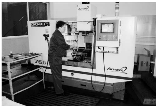
Рис. 7. Наш первый обрабатывающий центр с ЧПУ «Arrow» фирмы «CINCINNATI»
