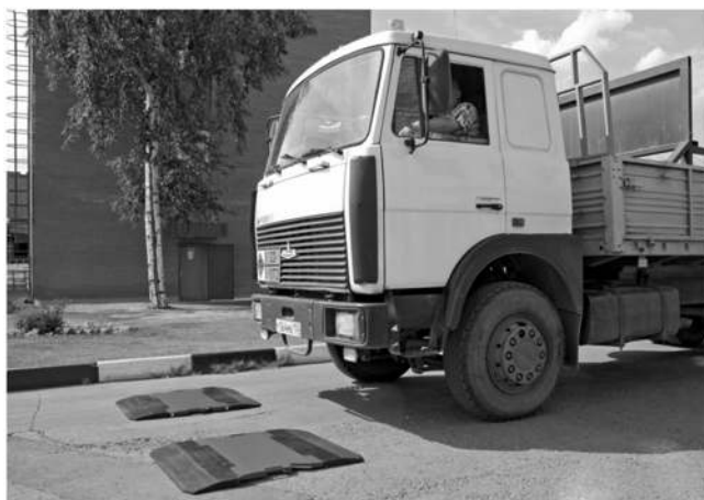
Рис. 9. Беспроводные портативные автомобильные весы ВА-20П, используемые сегодня практически всеми службами весового контроля грузового автотранспорта страны
