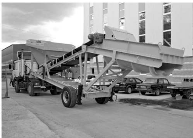
Рис. 11. Мобильная установка для производства холодного асфальта «МУХА»
