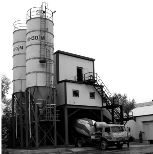
Рис. 8. Наша «проба пера» – бетоносмесительная установка АБСУ-30 на заводе крупнейшего производителя бетона в Москве – треста «Мосинжбетон»
